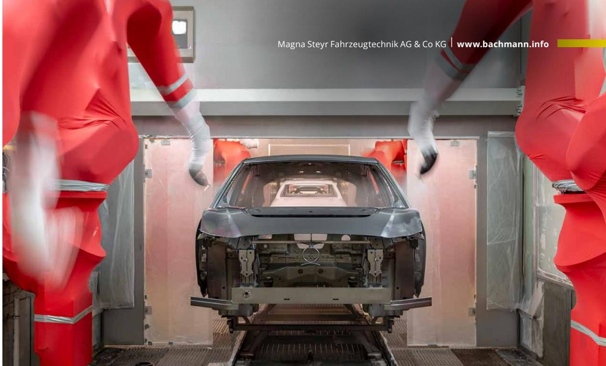
SCADA für Karosserielackiererei – Einsatzgebiet ist der gesamte Bereich der Lackiererei bei Magna in Graz (Österreich), und zwar von der Schnittstelle Rohbau bis zur Schnittstelle Endmontage. Die Anlage produziert max. 800 Karossen am Tag in drei Schichten.
