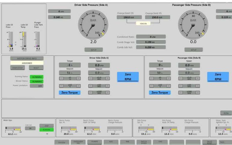
Darüber hinaus ermöglicht das entwickelte "Auto-Sequence"-Programm, dass die Operation wie geplant durchgeführt werden kann, ohne dass ein Bediener eingreifen muss. Hierdurch werden etwa 300 Bildschirmlklicks auf fünf reduziert.
