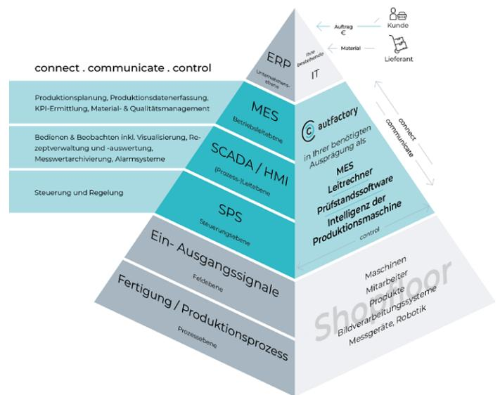
atvise® ist die Prüfstandssoftware von AUTFORCE, sie beginnt auf der SPS-Steuerungsebene und umfasst bis zur MES-Betriebsebene (Manufacturing Execution System) alle Bereiche. atvise® ist somit das Bindeglied zwischen der kundenseitigen IT-Umgebung und dem Ort der Wertschöpfung, dem zugehörigen Shopfloor.
