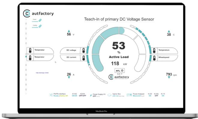
Die intuitive, atvise®-basierte grafische Bedienoberfläche führt den Benutzer sicher durch den Test-Prozess.
