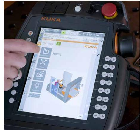
Visualisierung einer KUKA cell4\_production Fertigungszelle
